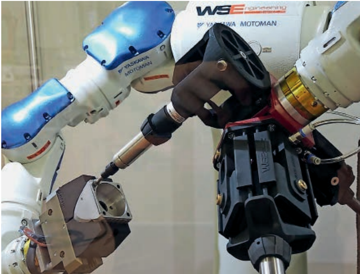
Die Roboter-Auslenk-Systeme von WS Engineering werden im 3D-Druck-Verfahren hergestellt. Foto: Visiotech
