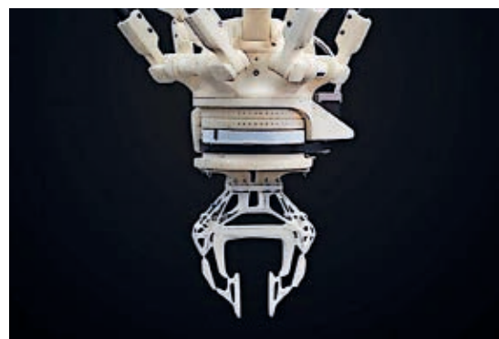
Durch Additive Manufacturing lassen sich völlig neue, bionische Greiferlösungen realisieren. Foto: Visiotech
