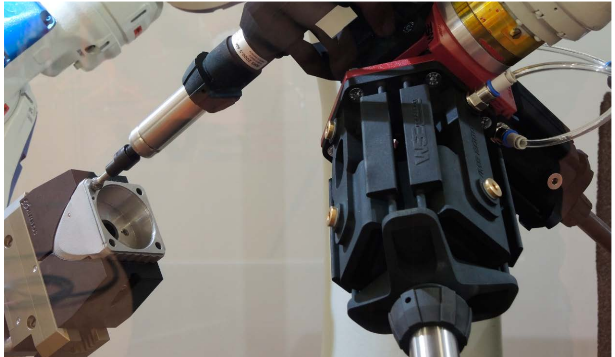
Generativ gefertigtes Auslenksystem für industrielles Entgraten (Lastersinterteil aus PA 12)
